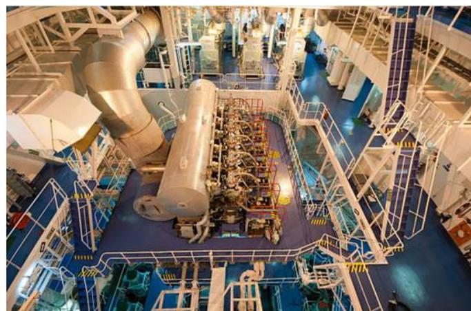
**Salle des machines d'un navire.** Cette zone du navire contient ses appareils propulsifs (turbines, moteurs) ainsi que des chaudières, et groupes électrogènes qui fournissent l'énergie utilisée à bord.
