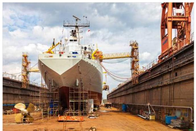
**Opération de maintenance sur un navire en cale sèche.** Cette opération permet de faire rentrer le bateau dans un bassin, puis d'en vider l'eau pour accéder aux parties inférieures et effectuer des réparations.
